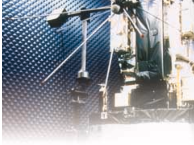
Reflexionsarmer Akustikprüfraum Fa. illbruck/F
