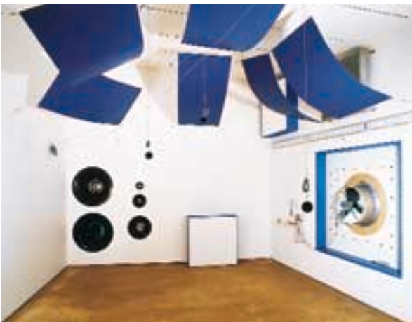
Akustikmeßraum mit einem Breitbandabsorber Fa. Metzeler/D
