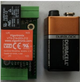
Ladecontroller: Herzstück und Koordinator mit dem CAN Fahrzeug Bus (serieller Datenbus) ist unser Ladecontroller. Er ist für ein- und dreiphasiges Laden geschaltet und kann zusätzlich auf eine maximale Abgabeleistung, aktuell 11 kW eingestellt werden. Alle Belegungen werden über Register und Eingänge vorgenommen (Pins 3+5 am PWM).
