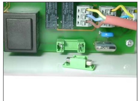
Feinsicherung 4 AT für die Absicherung des Heiz-Stromkreislaufes
